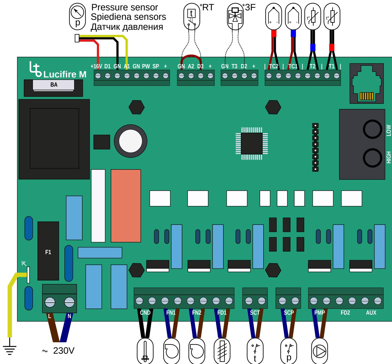
TC1 - firebox thermocouple | degkameras termopāris | термопара в топке
